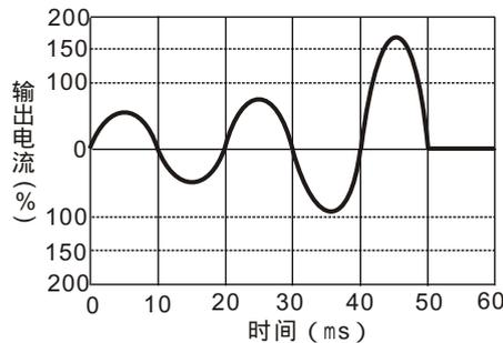
当输出电流大于额定值的150%时，过流环节在检测到过流信号后，半个周波时间（10ms）内自动截止输出并报警。
