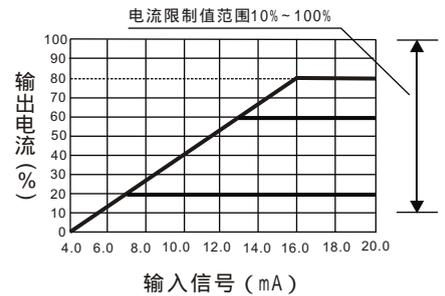
当负载电流达到电流限制值时，即使输入信号在增加，输出电流也不再增加。从而使负载电流限制在这一数值上不再增加。
